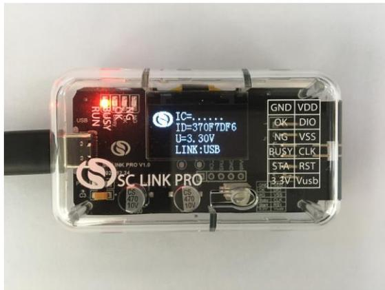
Figure 2.2.1 SC LINK PRO Display View
